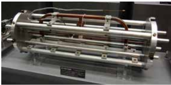
セシウム原子時計の共振部。セシウム原子時計では1億年に1秒しか狂いが起こらない。また、東京大学の香取教授によって開発されたストロンチウムを用いた光格子時計は、更に精度が高い160億年に1秒の狂いを実現している。 photo by Momotarou2012 License: CC BY-SA 3.0 ( https://creativecommons.org/licenses/by-sa/3.0 )
